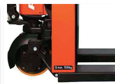
Sécurité Le tablier en acier protège les pieds du cariste et sécurise les composants du chariot contre les collisions.
