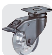
Roulette pivotante en tôle d'acier noire avec double blocage, roue en plastique translucide, palier lisse
